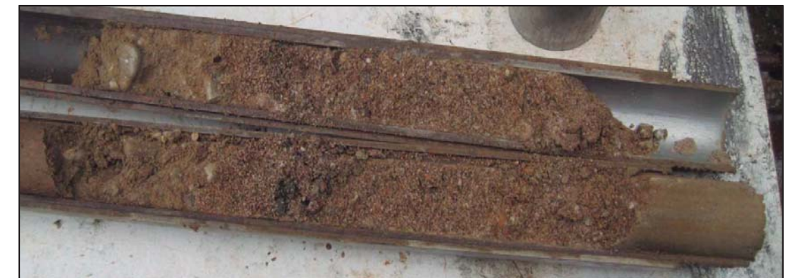
Sorres de la capa R1 recuperades en un assaig de SPT.
