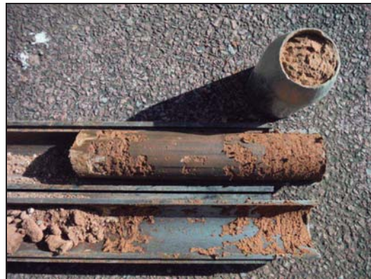
Foto 3: Sondeig S-1. SPT a 2,2 metres.
