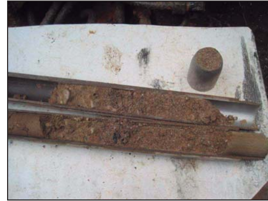
Foto 2: Sondeig S-1. SPT a 0,1 metres.
