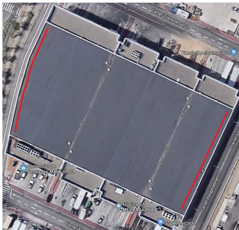
Esquema de la col·locació de la línia de vida a la coberta de l'edifici
